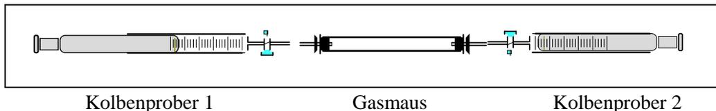
Das Biogas muss von der Gasmaus in einen Kolbenprober übergeführt werden.
