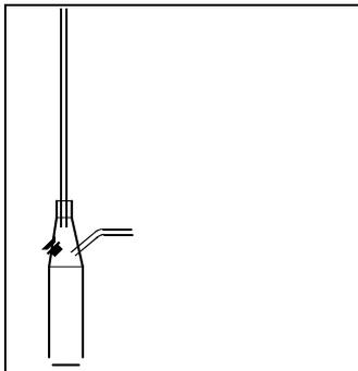
Leite so lange Erdgas durch die Apparatur, bis die gesamte Luft der Flasche verdrängt ist. Schließe den Gashahn und entzünde sofort am oberen Ende des Glasrohres das Gas. Entferne möglichst gleichzeitig den durchbohrten Stopfen mit dem Gaseinleitungs-Glasrohr, so dass Luft in die Flasche eindringen kann. Schließe den Abzug, schalte das Licht aus und warte ab.
